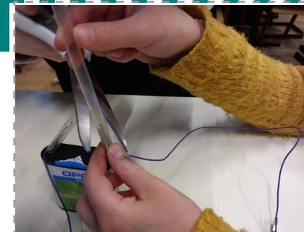
Assembler les trombones à la pile. Isoler avec la paille.
